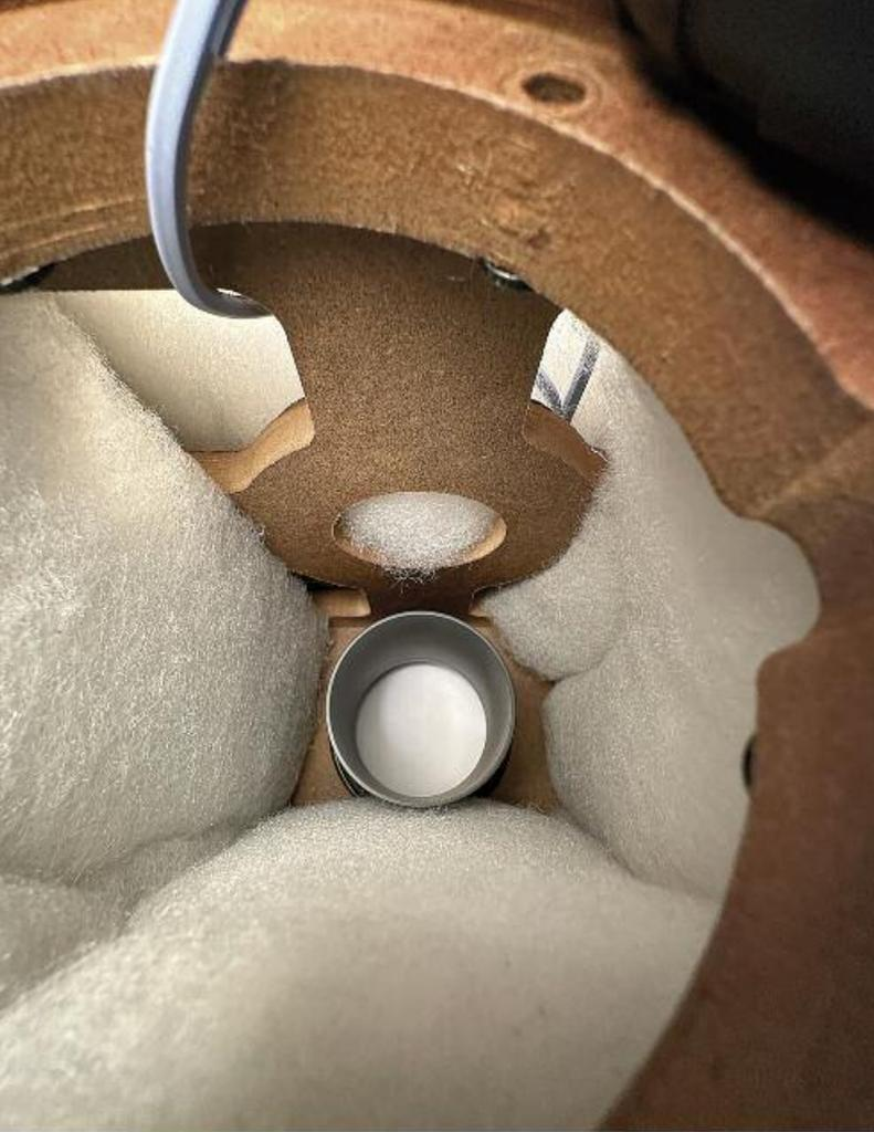
Links: Das Gehäuse aus MDF ist im Inneren so ausgestützt, dass dabei möglichst wenig Volumen verloren geht. Mitschwingen wird aber nicht komplett unterbunden, sondern bewusst in die Abstimmung einbezogen
