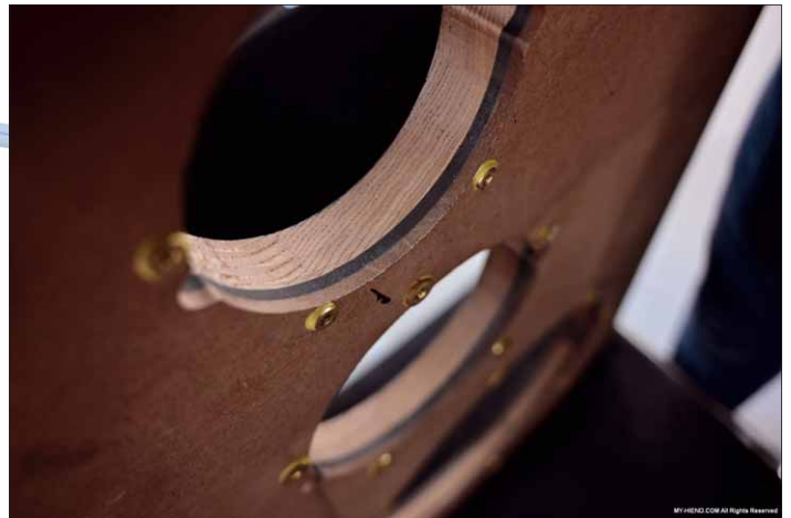
Mit der entsprechenden Sandwichbauweise kann man auch mit Echtholz gut arbeiten
